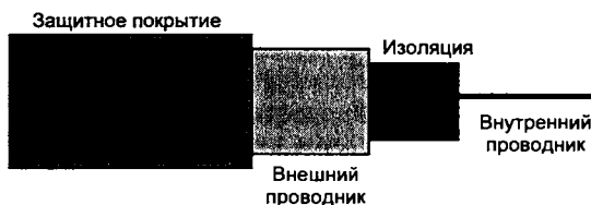
Рис. 9.11. Схема устройства коаксиального кабеля
